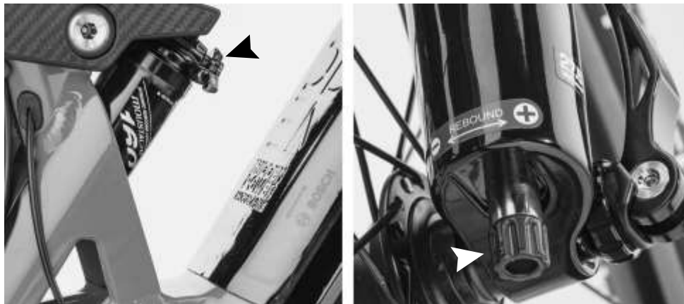
obr. 25. Príklad pre otočné kolieska na nastavenie odskoku: vľavo na tmiči, vpravo na odpruženej vidlici.
