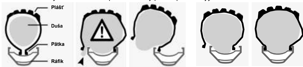
obr. 27. duša pricviknutá medzi plášťom a ráfikom
