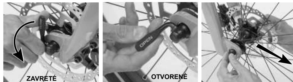
obr. 15. Otvorenie rýchlopínacej osky.
