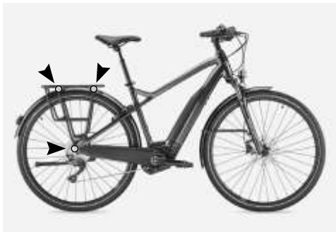
obr. 36. Upevňovacie body na klasickom nosiči batožiny.
