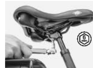
Anziehen/Lösen der Klemmschraube: obr. 8
