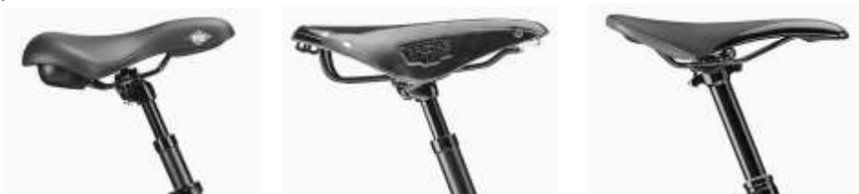
Obr. 5: Nastavenie sklonu sedla pri modeli Lundi 26 (vľavo), pri zmiešanom používaní bicykla (v strede) a pre MTB (vpravo).
