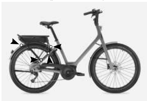
obr. 35. Upevňovacie body na nosiči batožiny s batériou.
