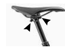
obr. 7. Sedlovka s dvomi upínacími skrutkami.
