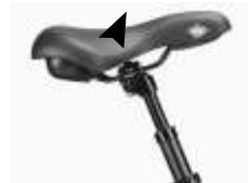
obr. 6. Sedlovka s len jednou upínacou skrutkou.
